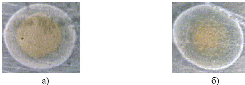
Рис. 2. Локальні оксидні покриття на сплаві АМg3 за швидкості руху сульфосаліцилатного електроліту а) 0,5 мл · с -1 , б) 0,3 мл · с -1
