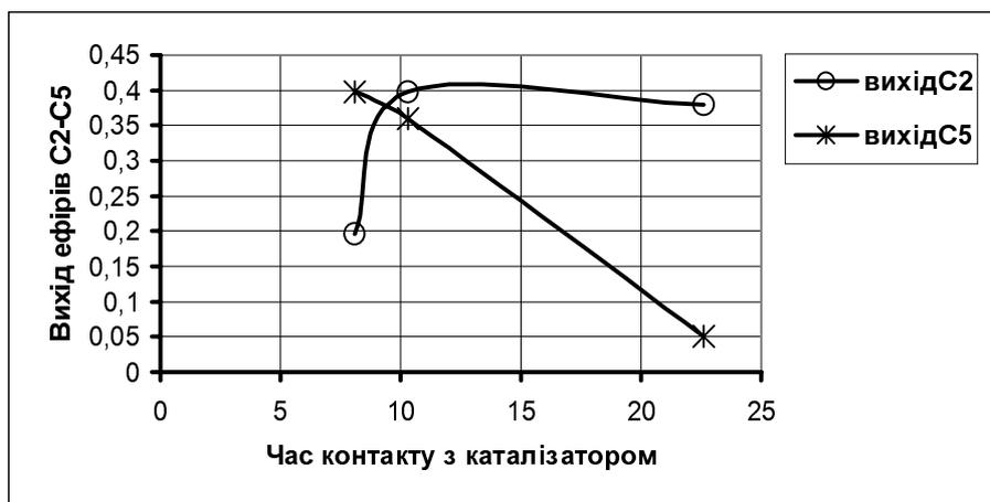
Рис.4. Криві залежності виходу діетилового і етил-ізоамілового ефірів від часу контакту з каталізатором етилового і ізоамілового спиртів при співвідношенні останніх 1:2 і температурі дегідратації 593К
