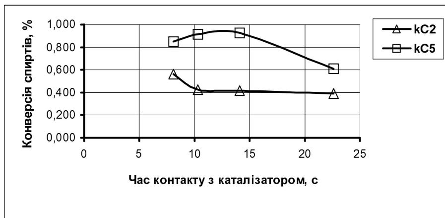
Рис.3. Криві залежності конверсії етилового та ізоамілового спиртів від часу контакту з каталізатором при їх співвідношенні 1:2 і температурі 593K
