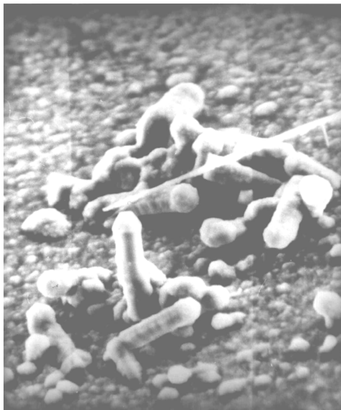
Рис. 1. Мікрофотографія НК Si (діаметр d = 3 мкм)
