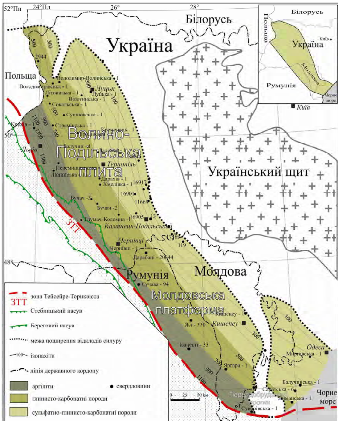
Рис. 4. Карта поширення та потужностей відкладів силуру південно-західного схилу Східноєвропейської платформи [Геотектоника..., 1990; Seghedi et al., 2005; Krzywicz, 2009; Radkovets, 2015]
