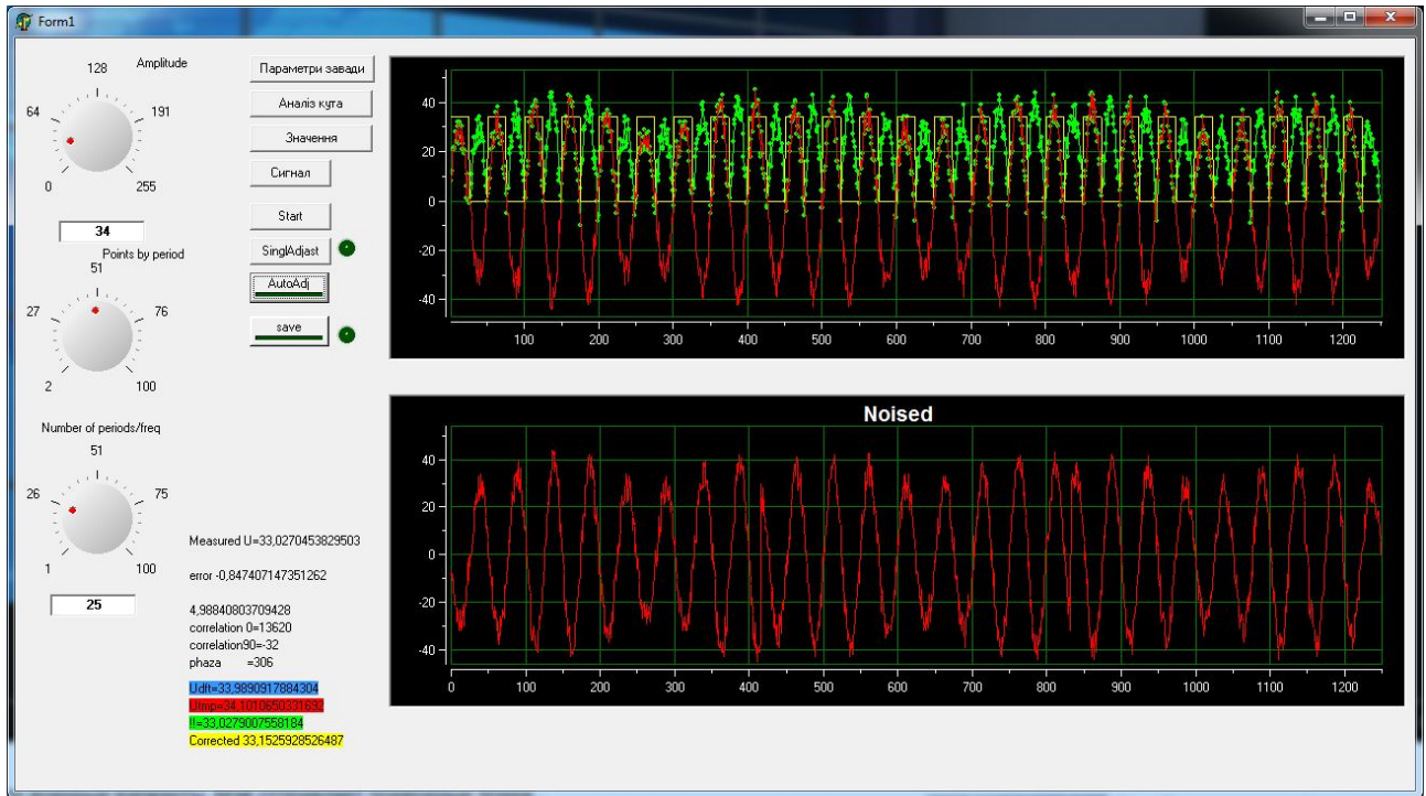
Рисунок 3.38—Приклад роботи програми симуляції авто системи визначення напруги
