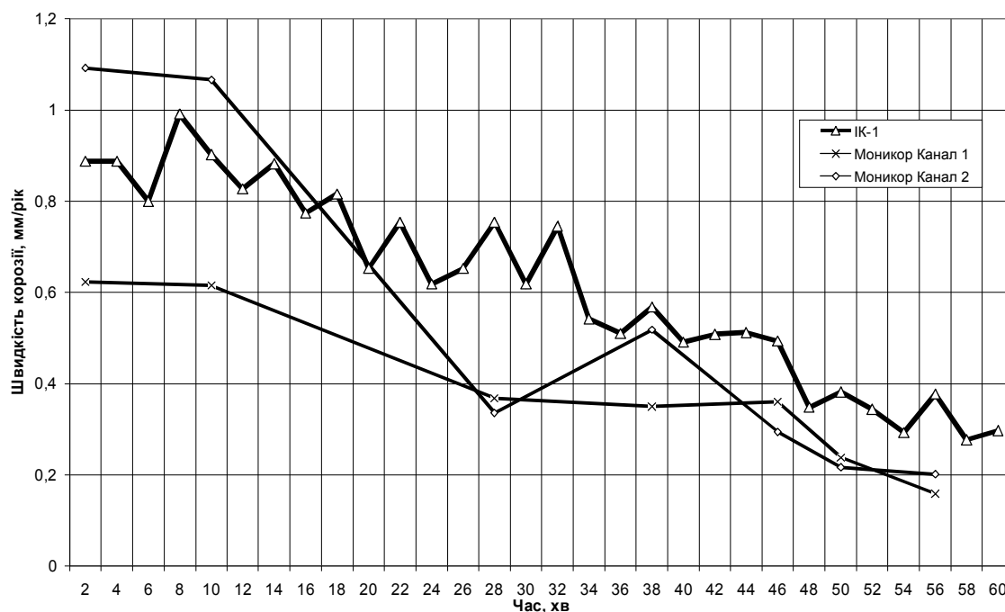
Рисунок 7.42 – Промислова порівняльна апробація розробленого взірця індикатора швидкості корозії "ІК-1" та корозиметра "Монитор - 2Л"
