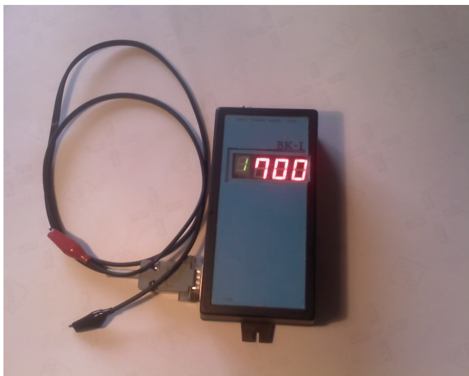
Рисунок Ж.3– Зовнішній вигляд автономного вимірювача швидкості електрохімічної корозії ВК-1(ІК-1)
