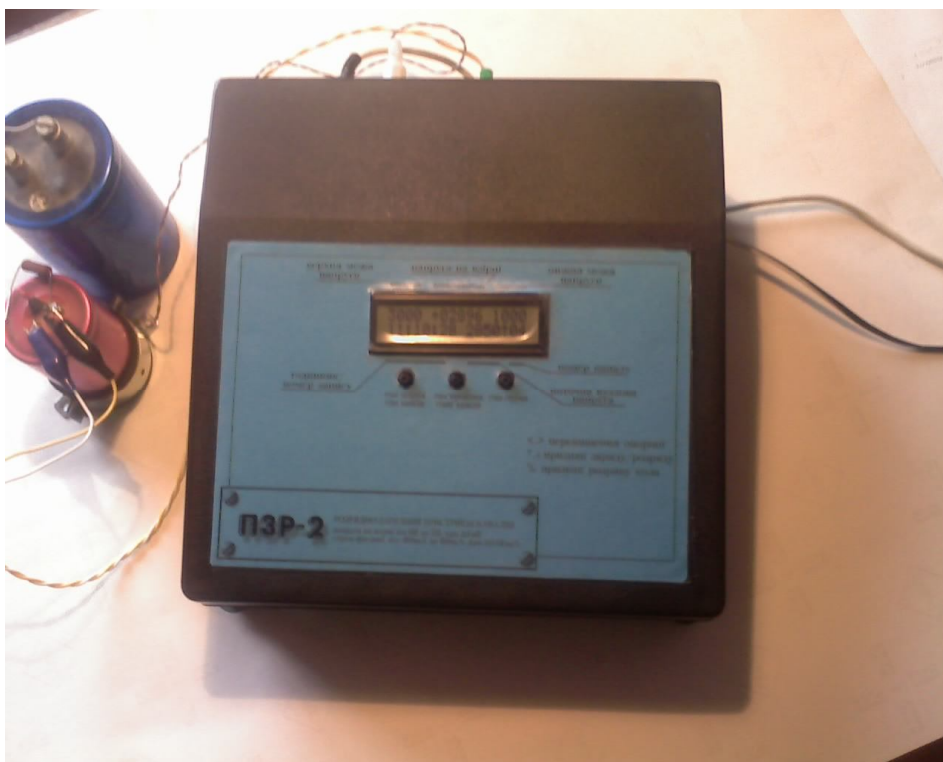
Рисунок Ж.1– Зовнішній вид розробленого восьмиканального гальваностата
