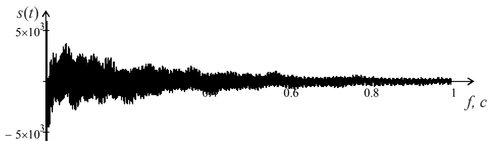
Рисунок 4.15– Сигнал отриманий при вимірюванні швидкості вільних коливань натягнутої металевої струни
