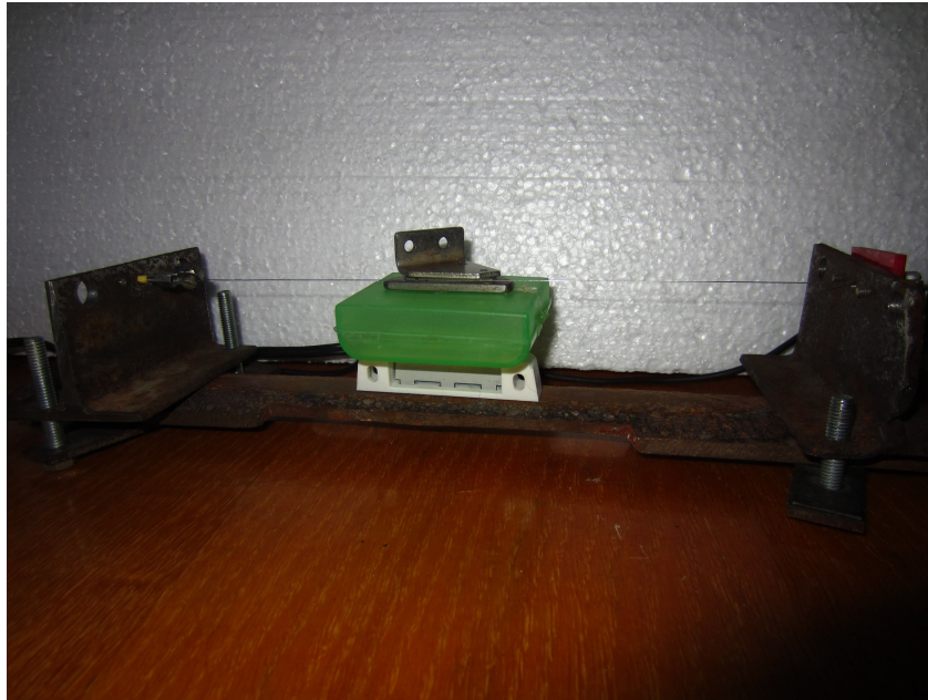
Рисунок 7.23– Зовнішній вигляд струни натягнутої на опорах, закріплених на досліджуваній пластині
