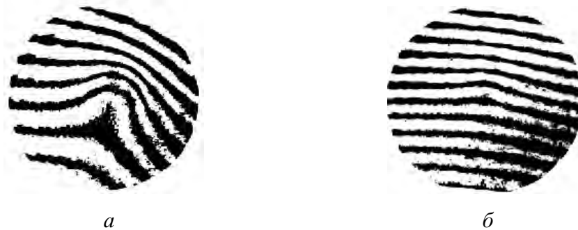
Рис. 4. Інтерферограми поверхні резонаторного дзеркала аргонного лазера при потужності пучка всередині резонатора 100 Вт: а – підкладка дзеркала із скла К8; б – підкладка дзеркала із плавленого кварцу КВ
