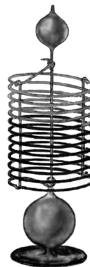
Рис. 3. Термометр флорентійських майстрів
