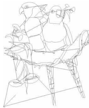
Рис. 3. Візуальне представлення неоптимальних переміщень інструменту при роботі по траєкторії, яка отримана на основі обчислення мінімальної відстані між елементами обробки
