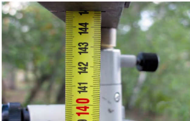
Рис. 3. Вимірювання висоти приладу методом фотофіксації (відлік 1448,0 мм)
