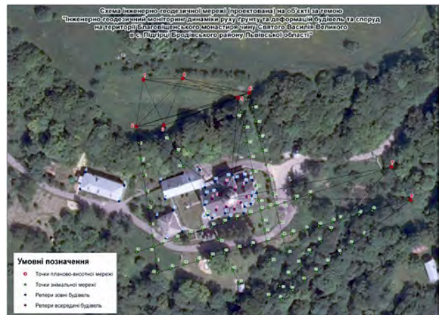
Рис. 7. Схема інженерно-геодезичної мережі на території Підгорецького монастиря
