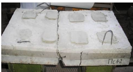
Рис. 7 Вигляд дослідної плити БП-1.1 після руйнування
