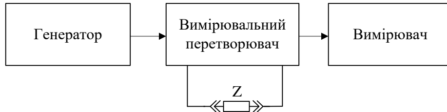
Рис. 1.4. Гальваностатичний метод вимірювання
