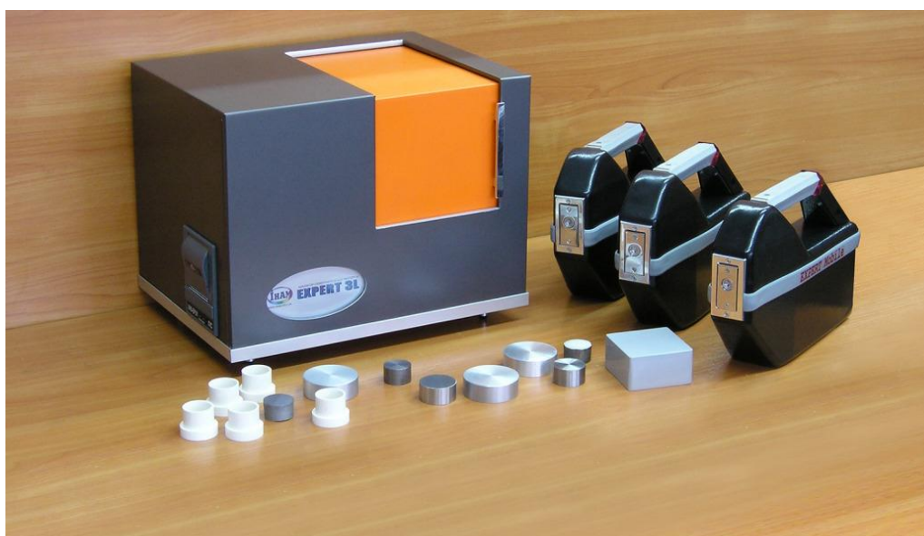
Рисунок 2.2 – Енергодисперсний рентгенофлуорисцентний аналізатор "EXPERT 3L"
