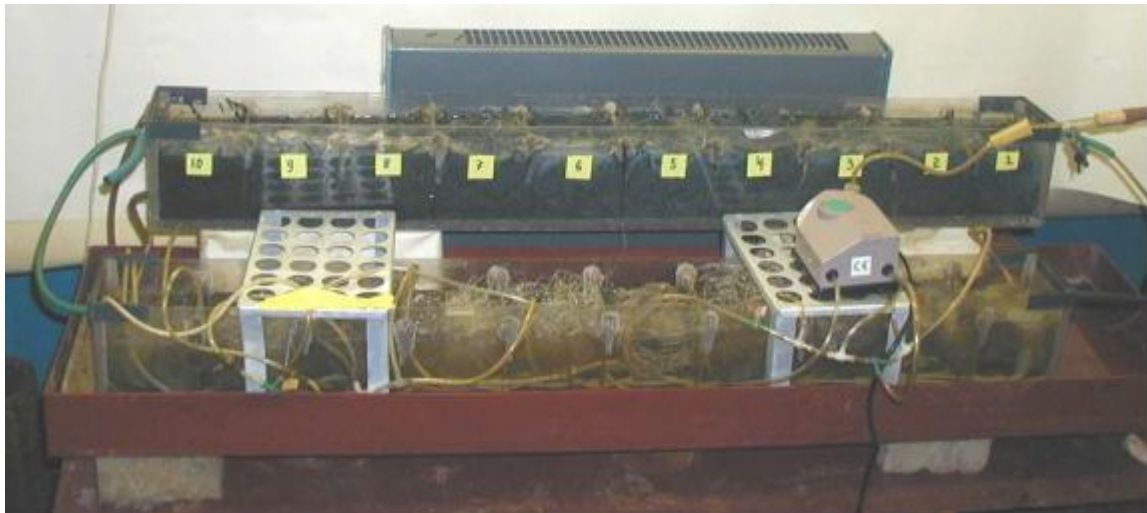
Рисунок 1.1 – Очисна установка для металовмісних стічних вод
