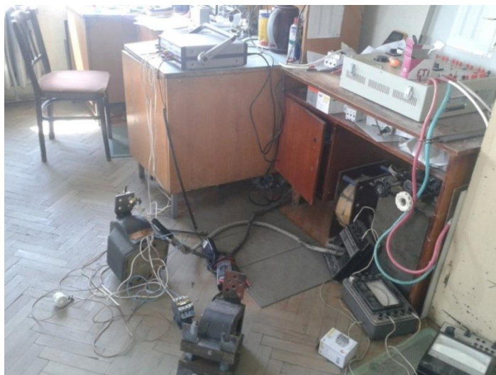
Рисунок 4.17 – Фото обладнання під час проведення натурних експериментів СЗ ТС типу ТЛМ-10 з застосуванням пробивного запобіжника типу ПП-А/3
