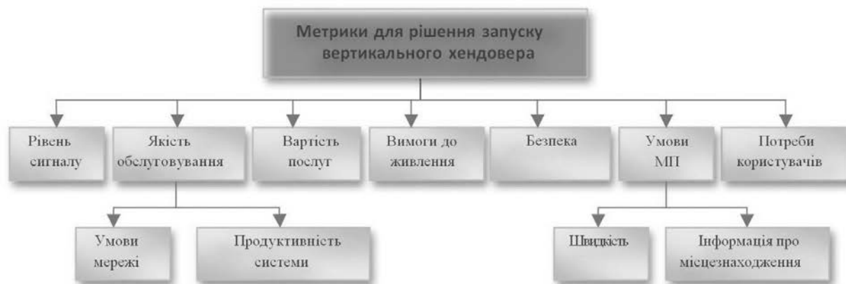
Рис. 4. Схема метрики для запуску вертикального хендовера
