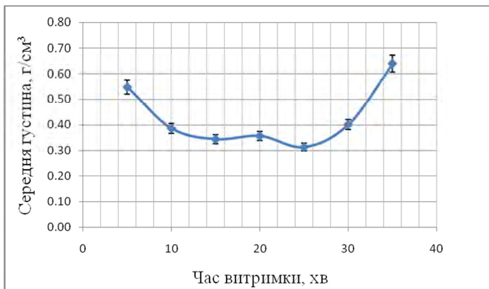
Рис. 6. Графік залежності середньої густини від часу витримки за температури 950 °С другого складу маси
