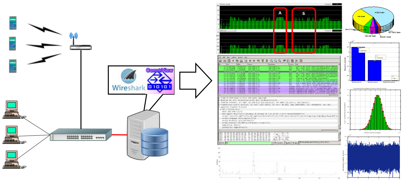
Рис. 3.1. Структурна схема експериментальної мережі для дослідження статистичних характеристик трафіку.
