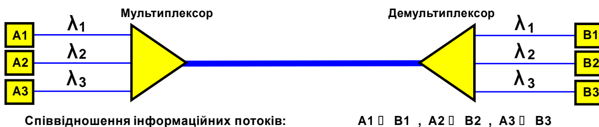
Рис. 1.3. Принцип функціонування системи зі спектральним ущільненням каналів.
