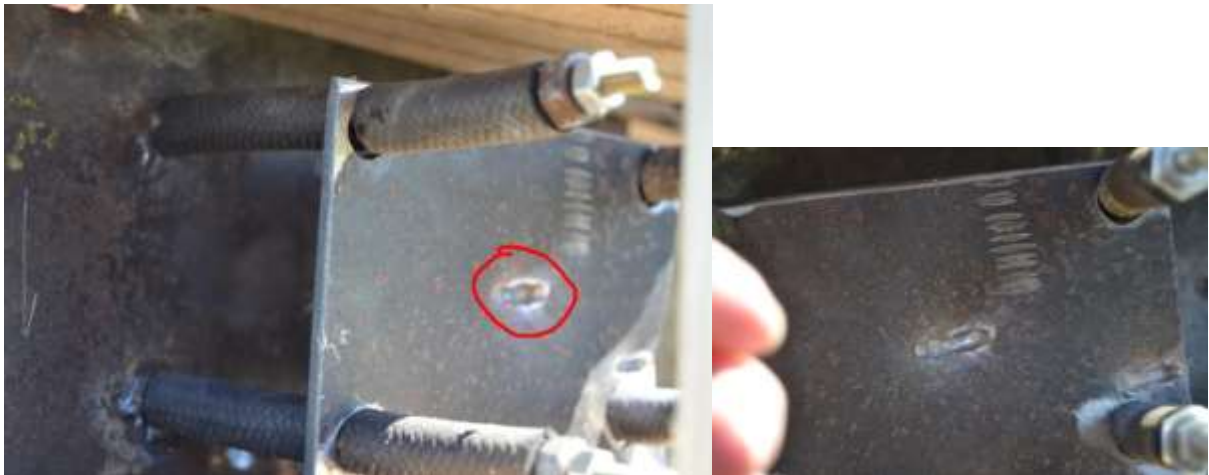
Фото 4. Рикошет кулі від підпружиненого елемента захисної конструкції
