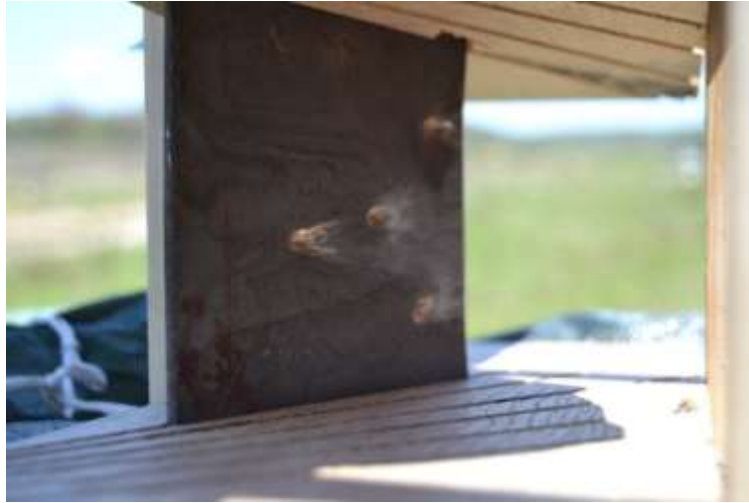
Фото 3. Полігонні дослідження захисної конструкції з жорстко закріпленою сталюю пластинуою
