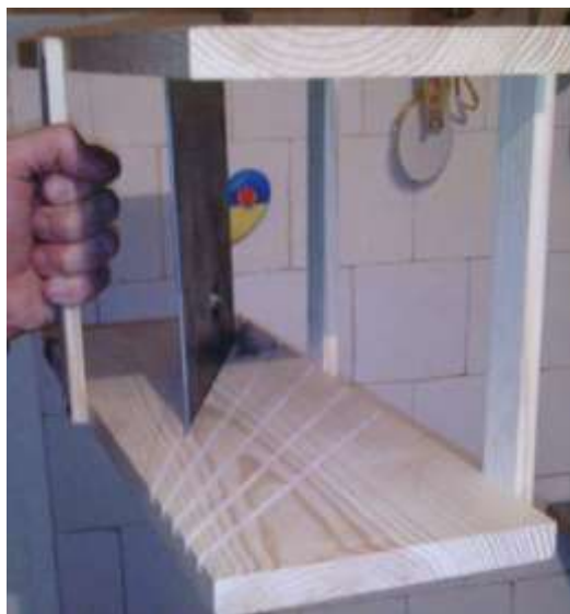
Фото 1. Жорстко закріплена сталеві пластина захисної конструкції
