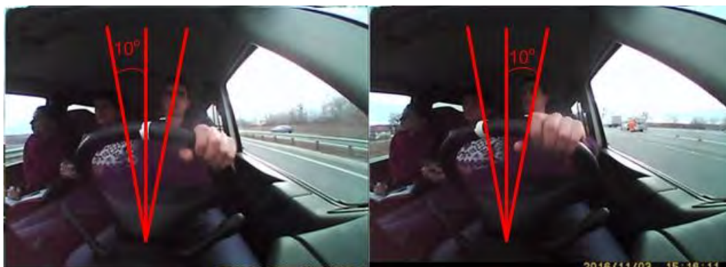
Рис. 1. Схематичне зображення методики вимірювання кута відхилення керма
