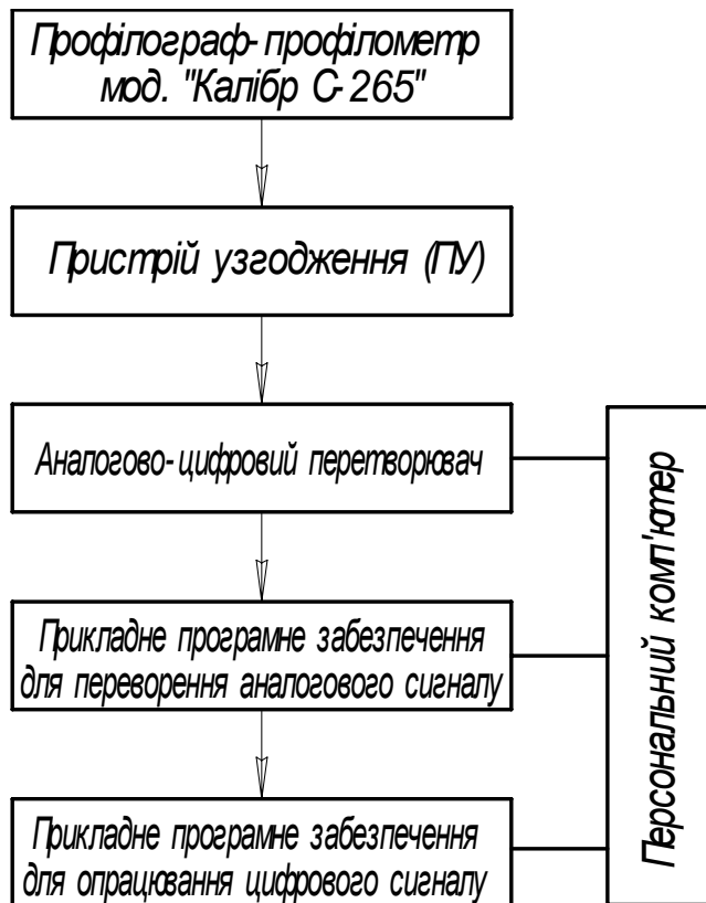
Рис. 2. Принципова схема вимірного комплексу для контролю мікрорельєфу поверхні
