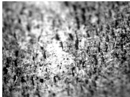
Рис. 3. Поверхні кочення модельних коліс зі сталей з нітридним зміцненням за варіантами сталей C_1 (а); C_2 (б); C_3 (в) після випробувань на контактну втому (збільшення \times 130 )
