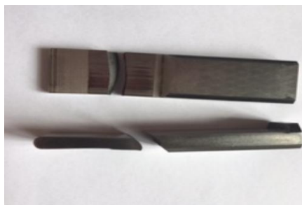
Рис. 3. Зруйновані пуансони конструкції до модернізації
