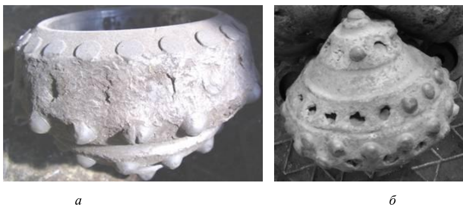
Рис. 1. Загальний вигляд зруйнованого породоруйнівного оснащення на найвантажніших вінцях шарошки тришарошкового бурового долота 269,9 ОК-ПВ: а – випадання і руйнування породоруйнівної частини твердосплавних зубців та завальцьовування вінця шарошки; б – випадання твердосплавних зубців шарошки
