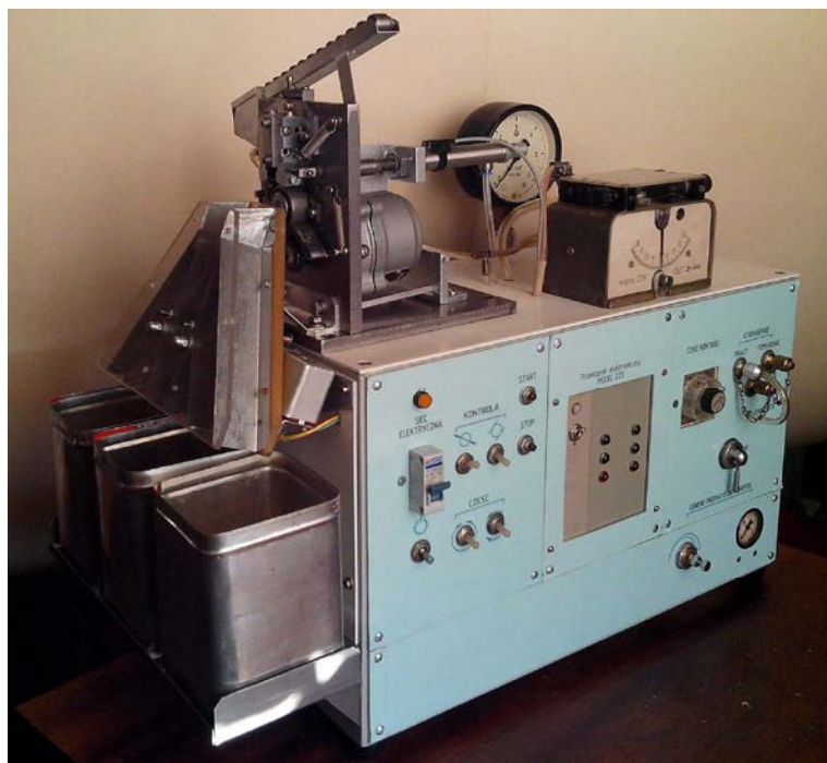
Рис. 4. Автомат для контролю діаметра і овальності прецизійних циліндричних деталей
