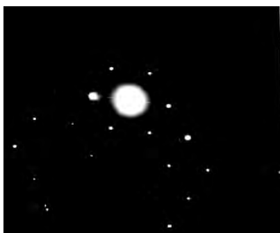
Рис. 2.30. Оптичні дифрактограми від електронних зображень AlN
