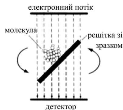
Рис. 2.41. Принцип електронної томографії [117]
