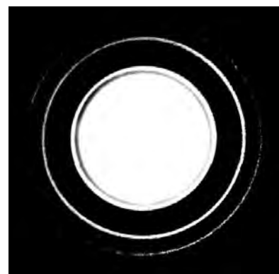
Рис. 2.29. Електроннограма від тест-об'єкта Al' плівка (електрохімічне осадження),
