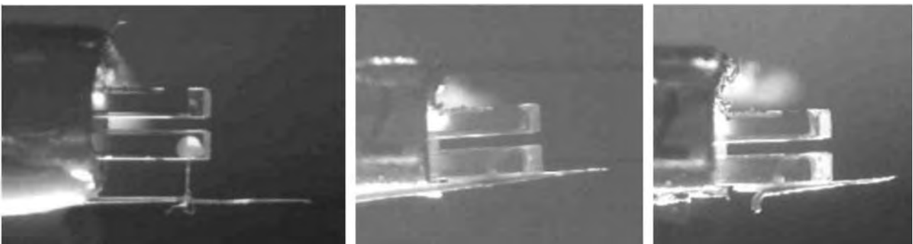
Рис. 1.16. Фотографії кварцового камертона з приклеєним загостреним ІЧ-оптоволоконном на основі AgClBr: а – через перемичку; б – до ніжки камертона; в – волокно обрізане
