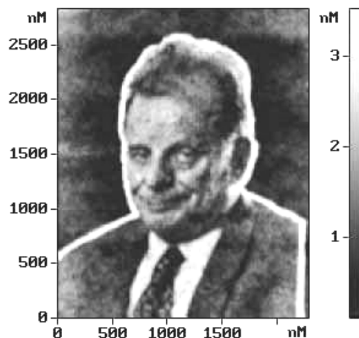
Рис. 3.13. Портрет Ж.І. Алферова, Нобелівського лауреата з фізики (2000) (АСМ-літографія, зображення отримана за допомогою методики локального зондового електричного окислення на надтонкій титановій плівці)
