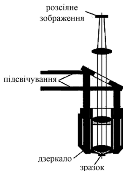
Рис.2.16. Схема темнопольної мікроскопії у світлі, що падає
