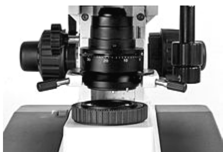
Рис.2.3. Система освітлення з конденсором
