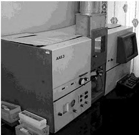
Рисунок 5.19 – Зовнішній вигляд атомно-абсорбційного автоматизованого спектрофотометру AAS-3 (Німеччина) з полум'яною атомізацією
