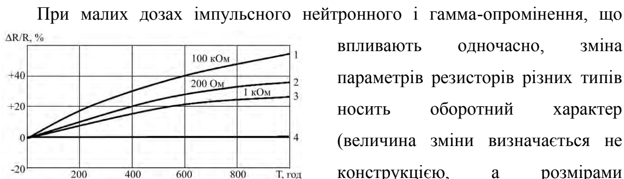
Рисунок 5.27 – Залежність опору ( \Delta R/R , %) тонкоплівкових (1-3) і дротяних (4) резисторів від тривалості ( T , год) гамма-опромінення при загальній дозі 2 \cdot 10^9 рад.
