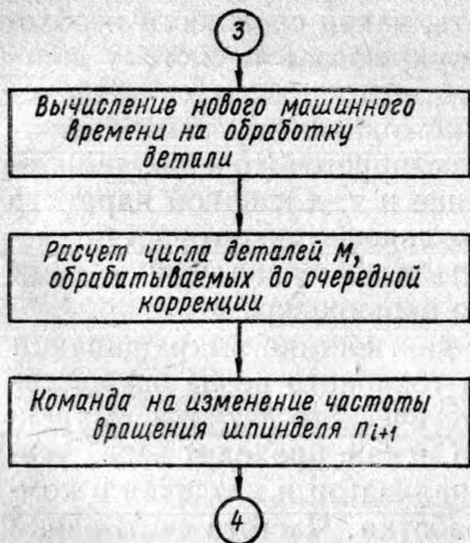
Рис. 40. Схема алгоритма оптимизации режимов резания при диагностике обработки фасонной детали
