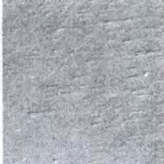
Рисунок 3.6 Топография поверхности подложки со следами бомбардировки частицами, x800
