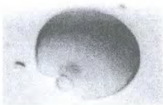
Рисунок 3.7 Капля катодного металла, на поверхности, SEM, \times 2500 , ( \tau = 10 с, T < 373 К)
