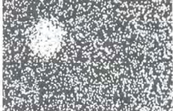
Рисунок 3.15 Распределение Ti (MPCА в характеристическом Ti-k_{\alpha} - излучении (белые точки – металл Ti), x2000
