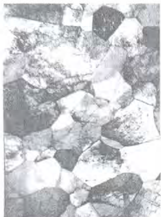
Рисунок 3.9 Микроструктура осажденной при ионной очистке частицы, TEM, \times 60\ 000
