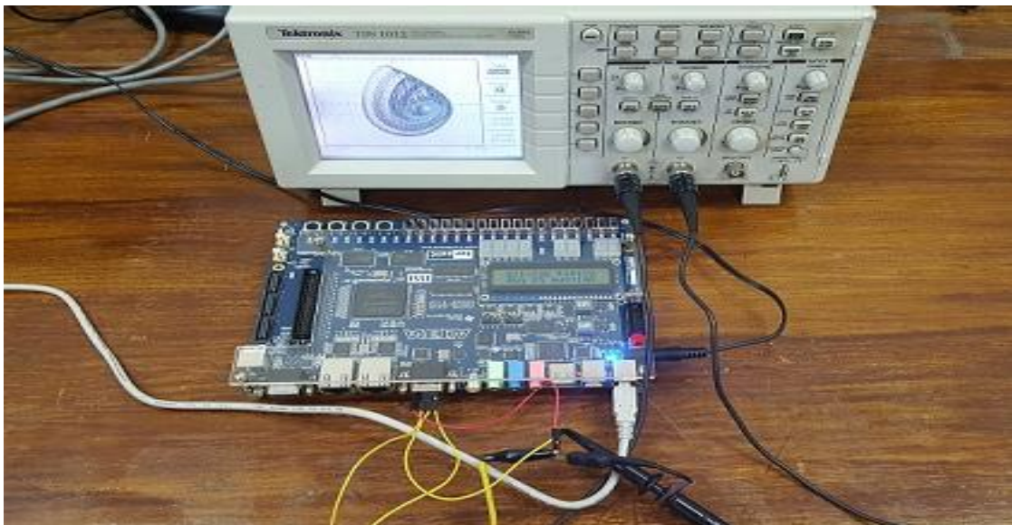
Рис. 3.21. Експериментально отримані фазові портрети при апаратній реалізації системи (3.3): a - x(y) , б - x(z) , в - y(z) , г - проведення експерименту
