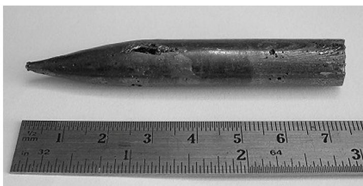
Рис. 6.15. Монокристалічний злиток InSe , вирощений методом Бріджмена
