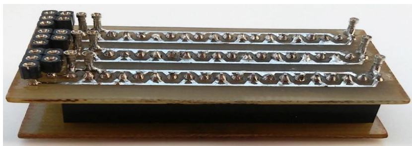
Рисунок 3.12 – Зовнішній вигляд експериментальної устави для дослідження транзисторів як сенсорів температури
