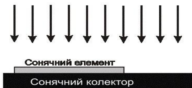
Рисунок 1.9 – Схема гібридної системи
