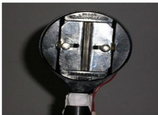
Рисунок 3.2 – Загальний вигляд термостовпчика
