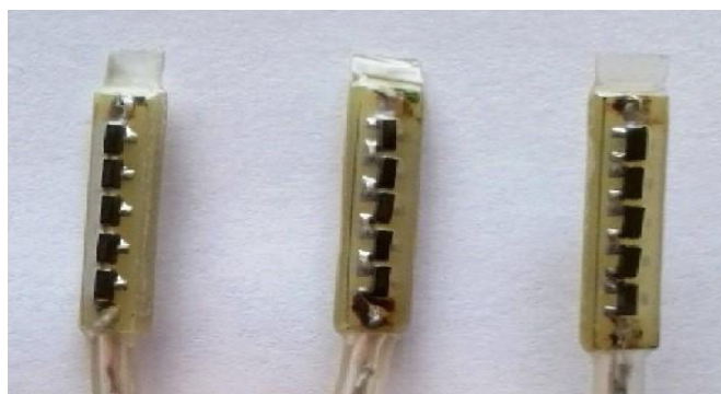
Рисунок 3.14 – Зовнішній вигляд транзисторних сенсорів температури
