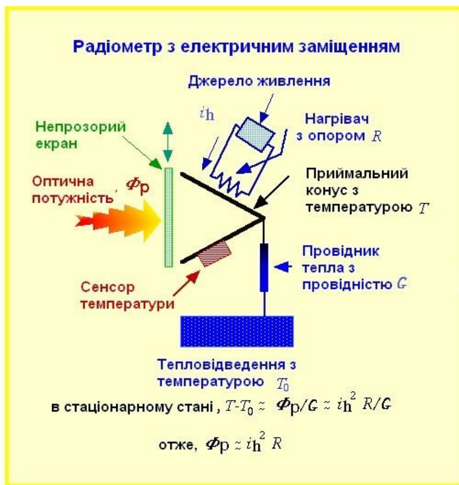
Рисунок 2.2 – Загальна схема радіометра з електричним заміщенням, де i_h є підвищений струм, що подається через нагрівач з опором R , необхідний для підтримки температурної стабільності
