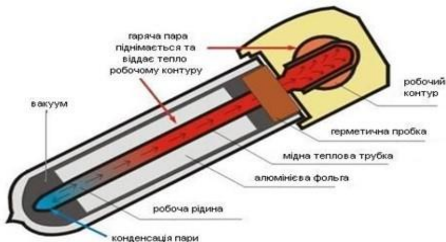
Рисунок 1.6 – Зовнішній вигляд типового вакуумного сонячного колектора
