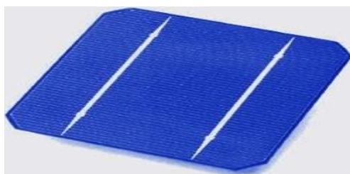
Рисунок 1.3 – Фотографія приймальної поверхні кремнієвого сонячного елемента
