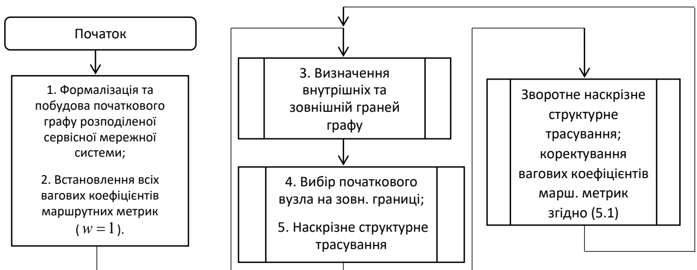
Рис. 5.1. Алгоритм коректування вагових коефіцієнтів маршрутних метрик для балансування сервісного навантаження за допомогою наскрізного структурного трасування в хмарній мережній платформі.
