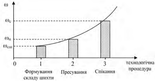
Рис. 4.8. Вплив технологічної операції спікання шихти на її хімічний склад і розміри феритової деталі:
