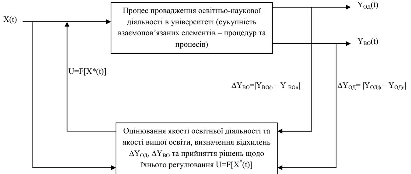
$X(t) = (x_1, x_2, \dots, x_n)$  – вектор вхідних змінних процесу, які характеризують стан системи у певний момент часу та можуть бути виміряні прямо або опосередковано;
