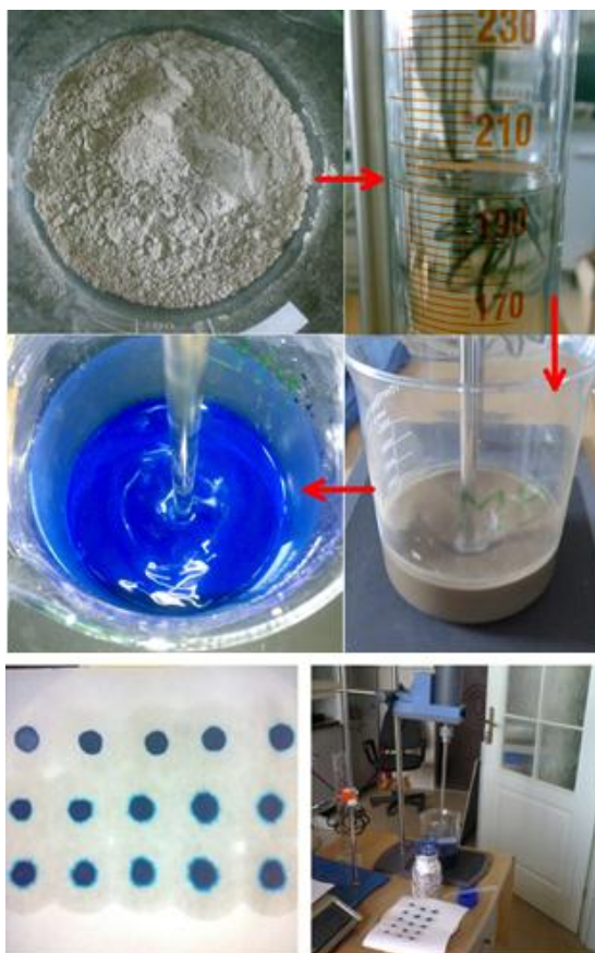
Рис. 2.4 Порядок проведення випробування з визначення адсорбції метилену синього
