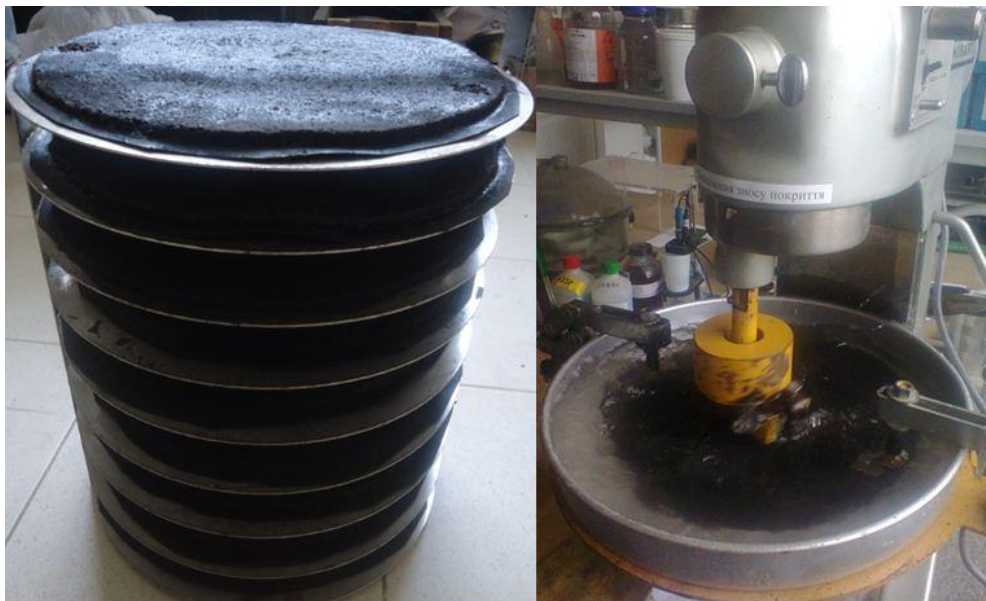
Рис. 4.20 Зразки з ЛЕМС перед випробуванням (зліва) та процес ВМВЗ за допомогою приладу Hobart C-100
