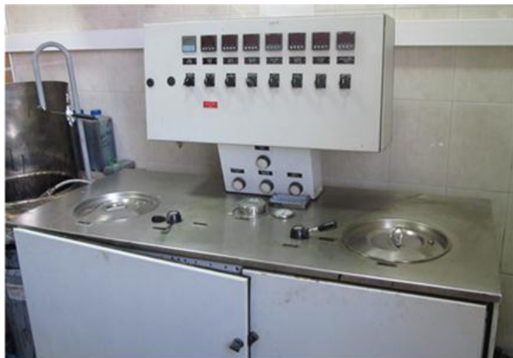
Рис. 3. Лабораторна бітумно-емульсійна установка SEP-0,3R
