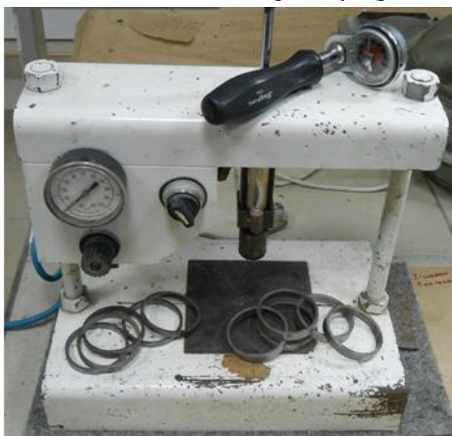
Рис. 1. Когезійний прилад та кільця-форми
