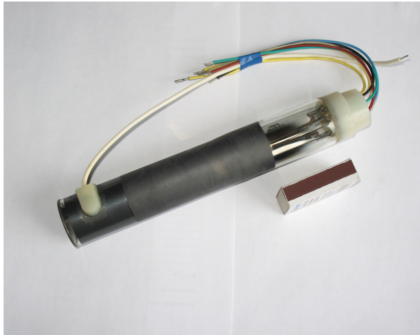
Рисунок 1.5 – Загальний вигляд сканувальної ЕПТ високої роздільної здатності типу У4ТП1И
