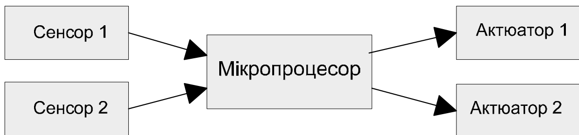
Рис. 4. МЕМС з двома сенсорами та двома актюаторами
