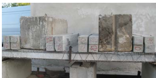
Рис. 2. Завантаження тришарової плити: а – за схемою I, б – за схема II; 1 – дослідний зразок; 2 – блоки вагою 47 кг, 3 – блоки вагою 720 кг.
