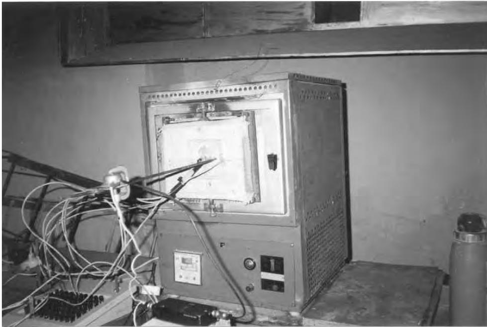
*Рис. 2. Вигляд установки для випробувань бетонних кубиків на вогнестійкість*
