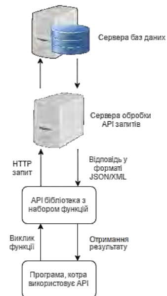
Рис. 1. Схема роботи з використанням API
