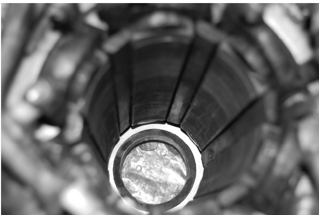
Рис. 15. Дослідний зріз статора генератора
