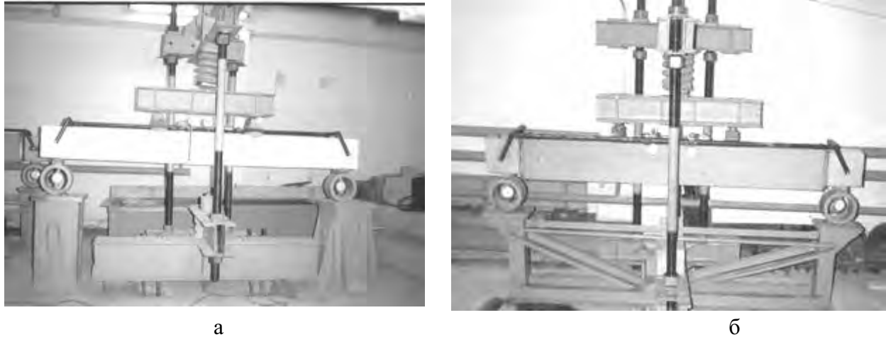
а б Рис. 1. Стенд для експериментального випробовування балок: а – на довготривалі навантаження; б – на сумісну дію агресивного середовища і силового довготривалого навантаження
