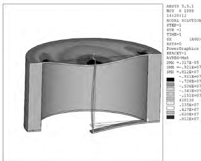
Рис.1. Розподіл механічних напружень в основних елементах конструкції високотемпературного сенсора тиску з універсальним тензододулем
