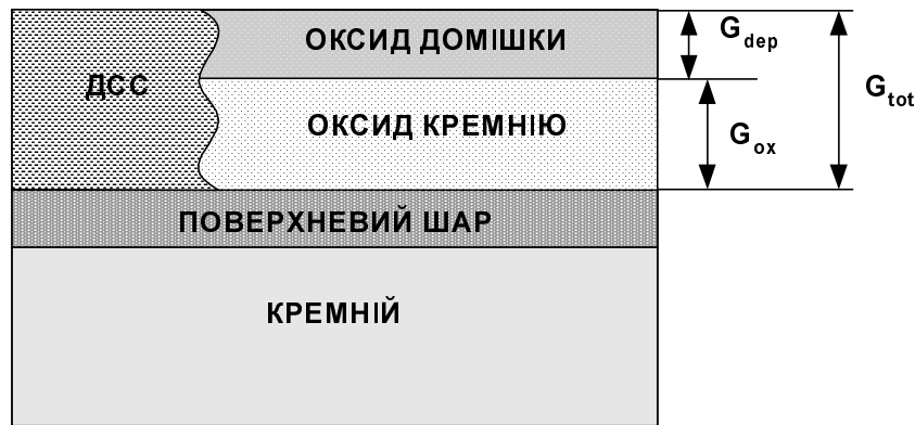
Рис.2. Схематичне зображення плівки на поверхні кремнієвої пластини
