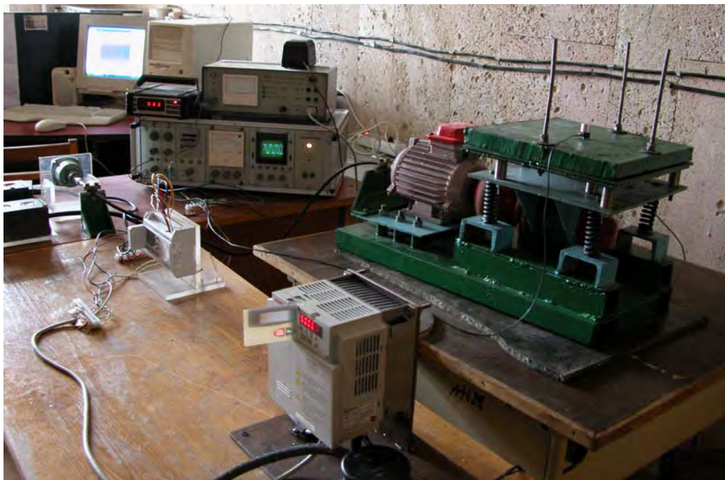
Рис. 1. Загальний вигляд обладнання та експериментальної установки на якій досліджували перехідні процеси у ВТМ та АВТМ
