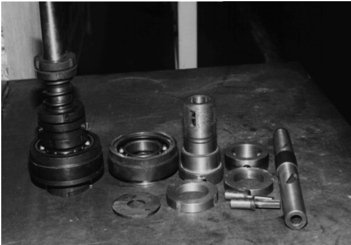
Рис. 1. Розточувальна головка для розточування кільцевих канавок
