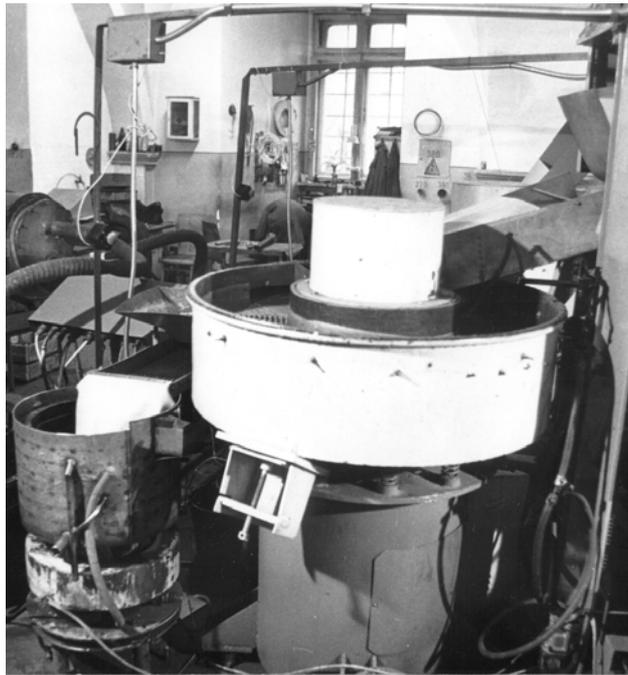
*Рис. 2. Вібраційна машина з торовою робочою камерою і автоматичною сепарацією деталей*
