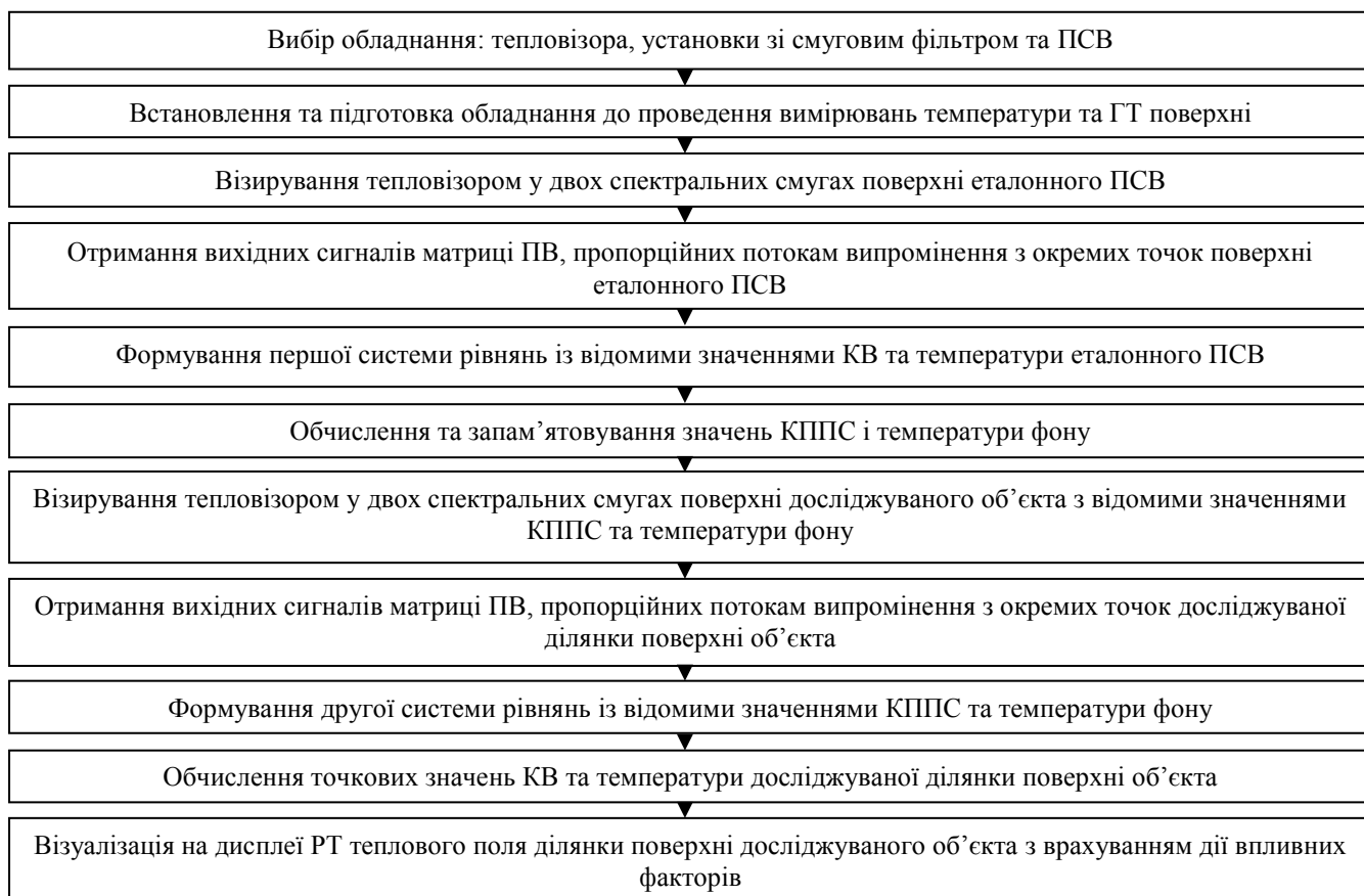
Рисунок 4 – Послідовність виконання операцій методу вимірювання температури та ГТ за ІЧВ поверхні об'єкта дослідження
